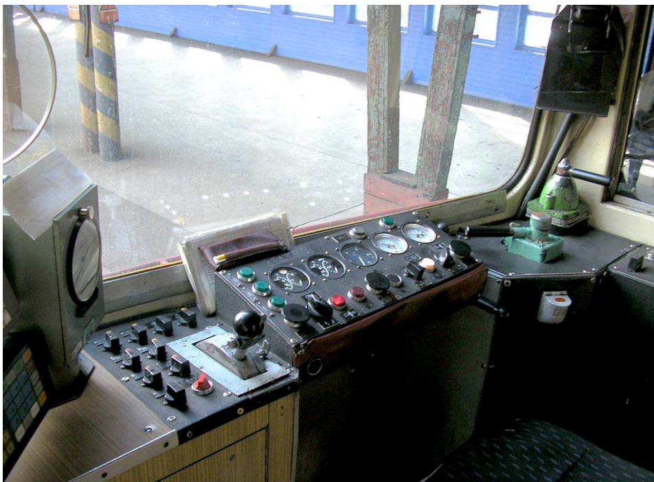
Obrázek 14: Stanoviště strojvedoucího lok. ř. 810
