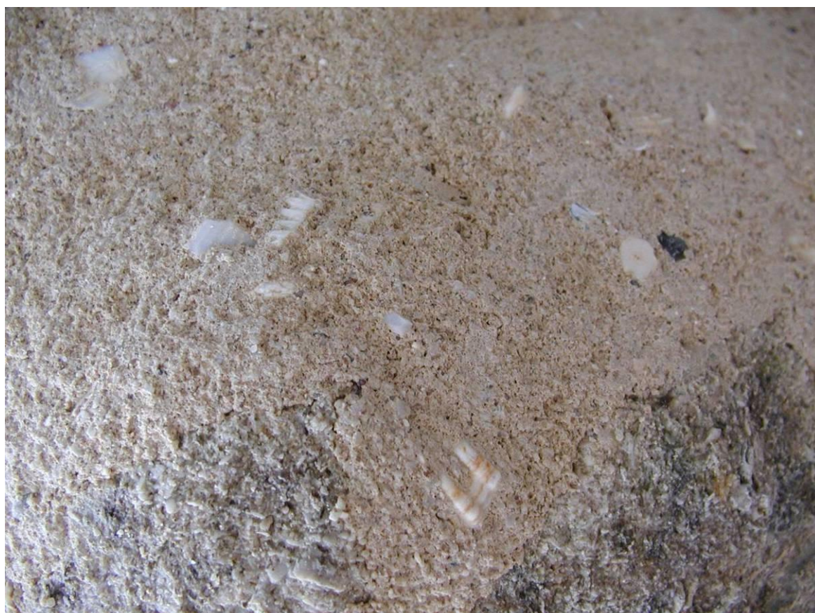
Obr. 50: Struktura tmelu s drcenými lasturami.
