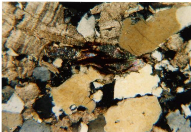
Vápenec biodetritický, písčítý s glaukonitem, BS – 3, poupě, zvětšení 32x, nikoly X Struktura: křemen, slída (muskovit), biodetrit, hematit
