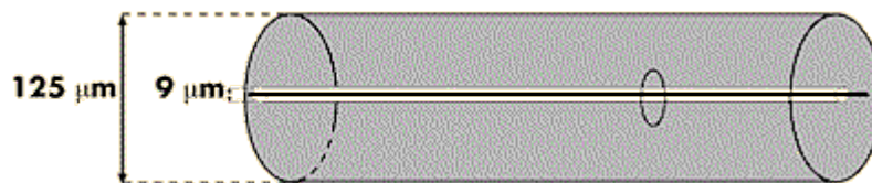
Obrázek 9 - Šíření paprsků v jednovidovém kabelu
