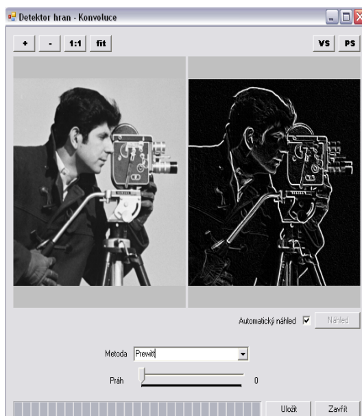
Obrázek 49 – Výsledné okno detekce hran pomocí výpočtu konvoluce
