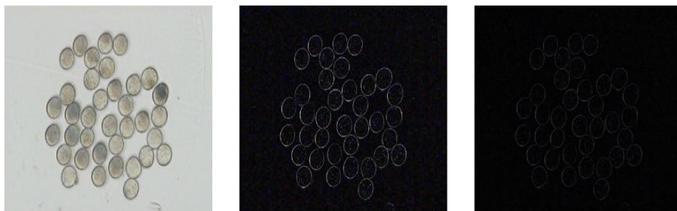
Obrázek 22 – Ukázka aplikace různých Laplaceových operátorů (zdroj: [9])
