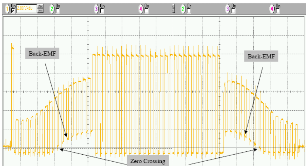
Obrázek 3.12 Fázové terminálové napětí a průběh BEMF (11)
