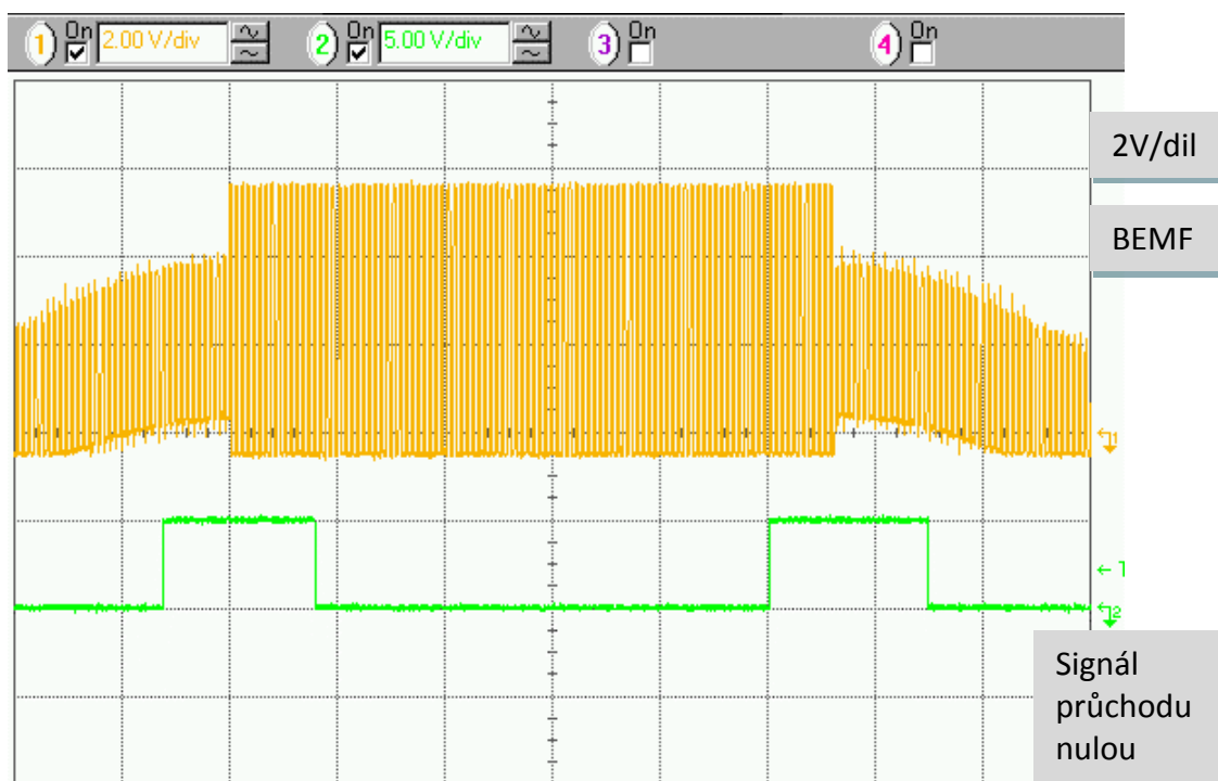
Obrázek 3.15 BEMF a křížení nuly pro provoz o nízkých otáčkách (11)
