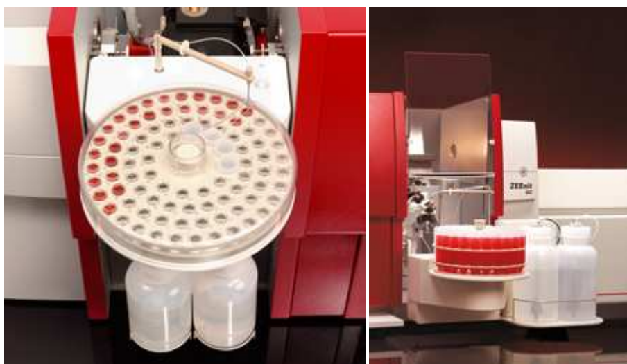
Obr. 27 Automatický systém dávkování kapalných vzorků pro elektrotermický, resp. plamenový atomizátor AA spektrometrů spol. Analytik Jena
