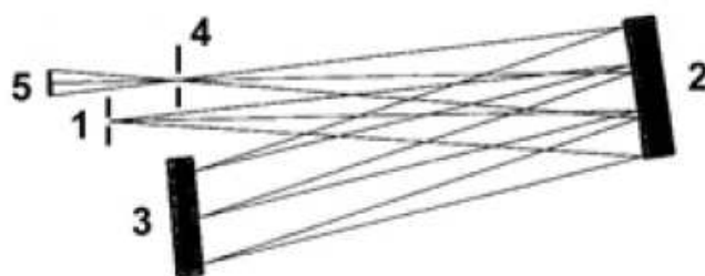
Obr. 12 Monochromátor typu Litrow: 1 – vstupní štěrba, 2 – konkávní zrcadlo, 3 – difrakční mřížka, 4 – výstupní štěrba, 5 – detektor
