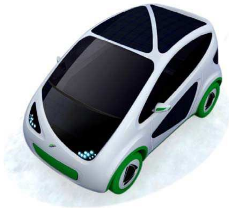
Obr. 29 Příklad použití solárních panelů u vozidla Fiat Phylla
