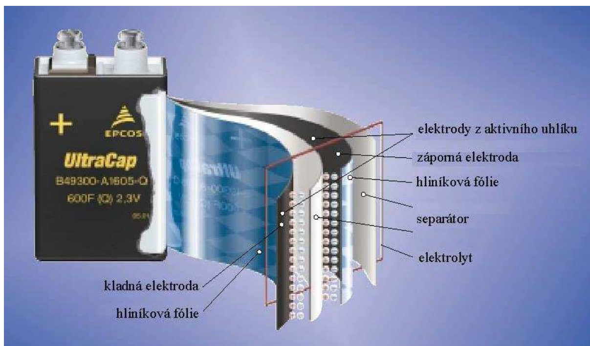
Obr. 26 Struktura superkondenzátoru
