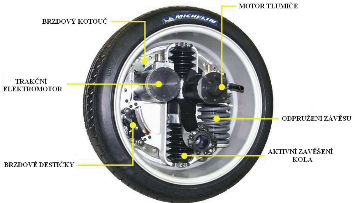
Obr. 33 Příklad umístění trakčního elektromotoru přímo v kole (Michelin Active Wheel) [6]
