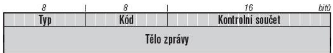
Obrázek 3: Formát ICMPv6 zprávy [1]
