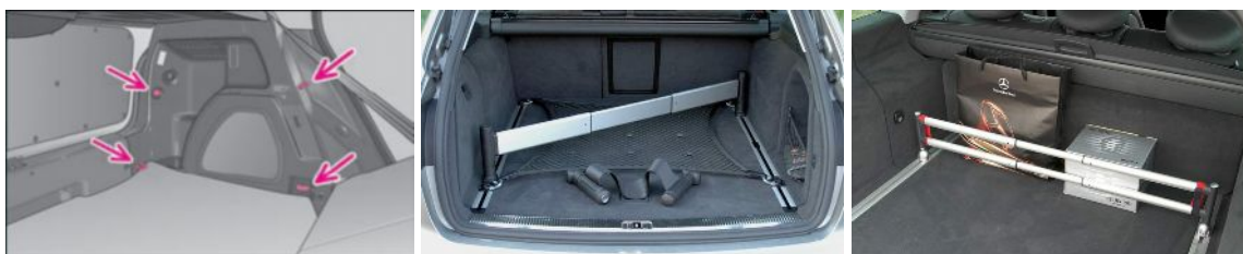
Obr. 2.16 Upevňovací oka pevná, posuvná, demontovatelná přepážka [4, 7]
