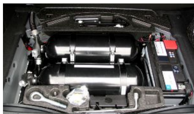
Obr. 2.25 Umístění nádrže na LPG v prostoru rezervního kola [7]
