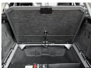
Obr. 2.10 Fixace mezipodlahy v horní poloze pomocí plynové vzpěry [7]
