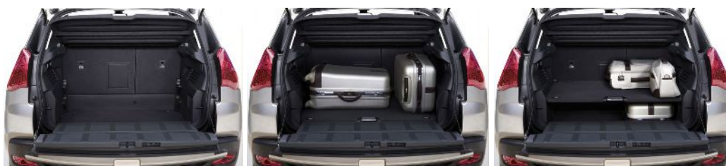
Obr. 2.12 Možnosti uložení polohovatelné podlahy [7]
