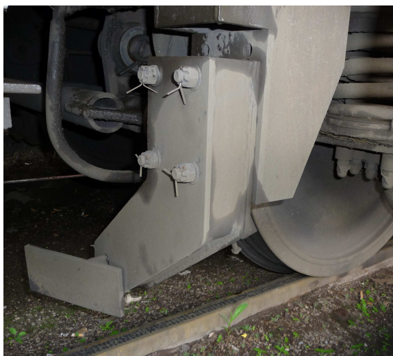
Obrázek 12 Zábrana na rámu podvozku u řídicího vozu 954 ČD
