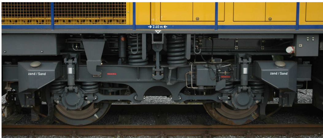
Obrázek 22 Obvyklé řešení pískování většiny čtyřnápravových lokomotiv
