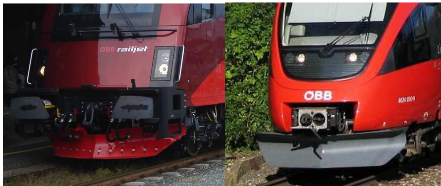
Obrázek 11 Obvyklé řešení pluhu z jednoho kusu plechu
