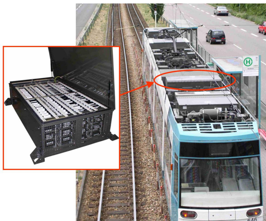
Obr. 18 Umístění systému MITRAC na střeše vozidla GTN6 [ 10 ]
