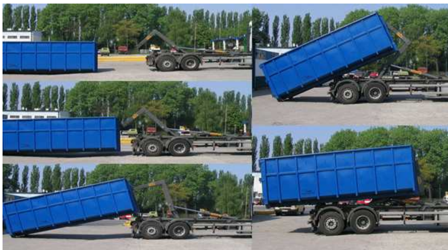
Obrázek 13: Schéma nakládky odvalovacího kontejneru hákovým nakladačem
