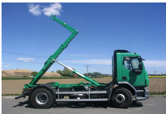
Obrázek 12: Hákový nakladač ve vyklápěcí poloze
