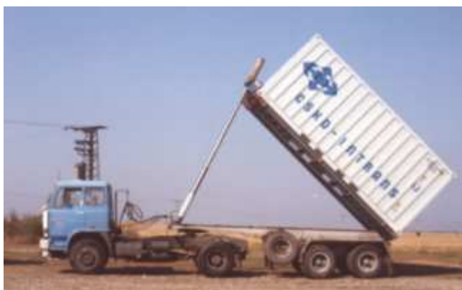
Obrázek 11: Sklopný návěs při vykládce
