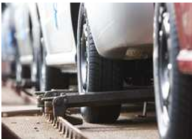
Obrázek 1: Sklopná zarážka na železničních vozech pro přepravu automobilů
