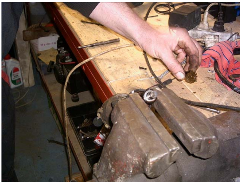
Obr. 4.1 Odřezané ozubené kolečko olej. čerpadla
