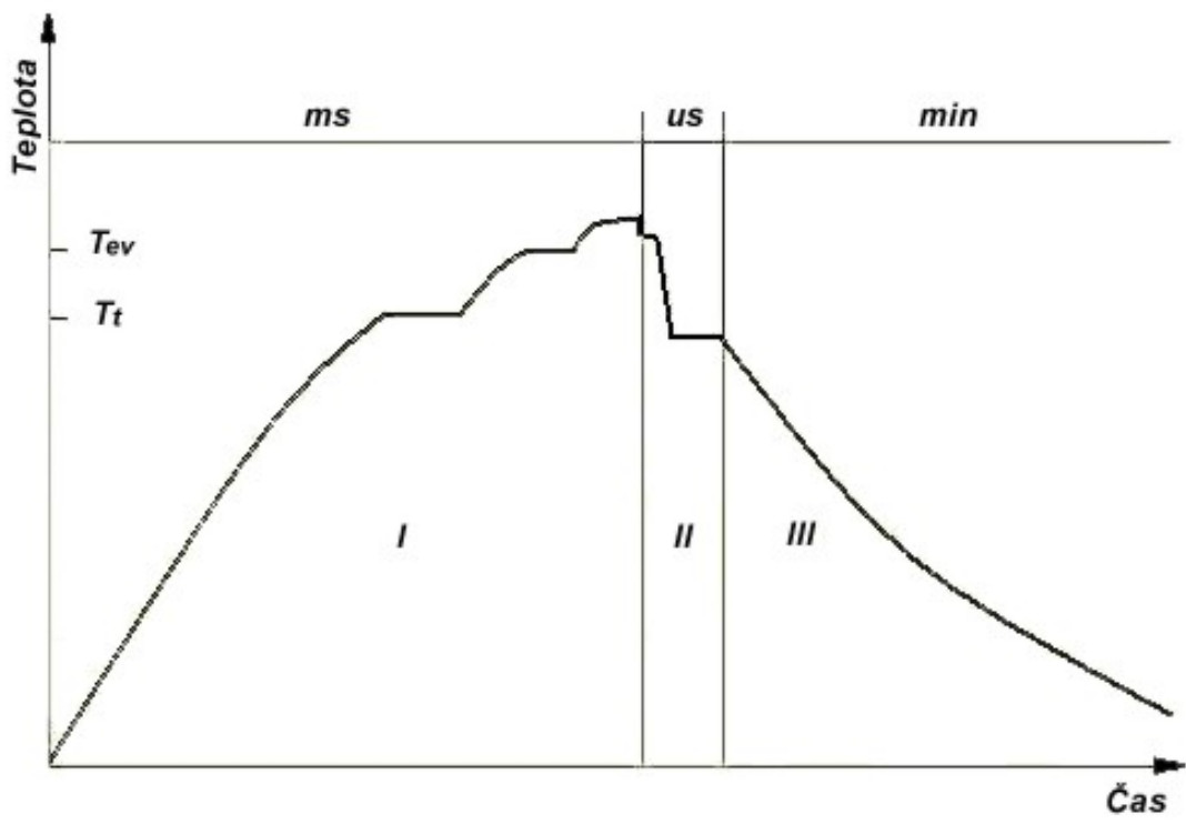
Obr 1.3c Tepelná historie částice I v plameni - natavení II po dopadu na substrát – deformace a utuhnutí III součást povlaku - ochlazování
