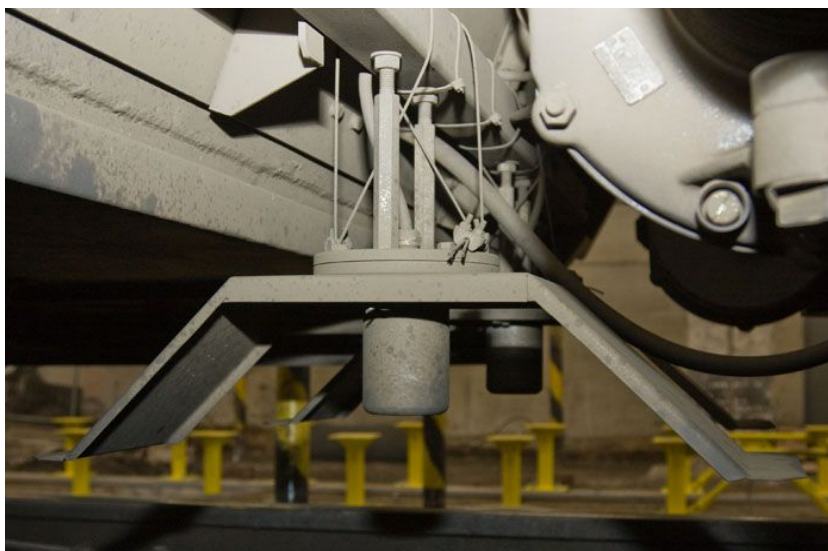
Obrázek 3: Dvojice snímačů informací z bodů MIB-6
