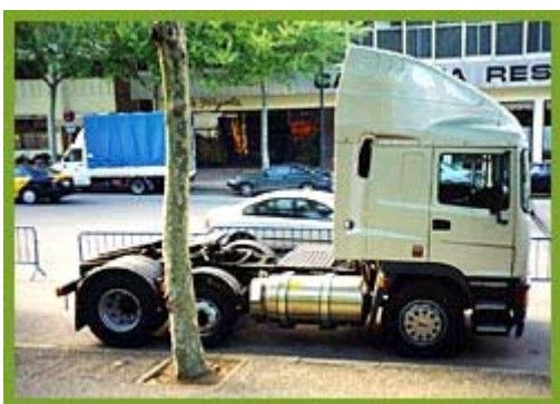
Obr. 16: Umístění LNG nádrže [11]
