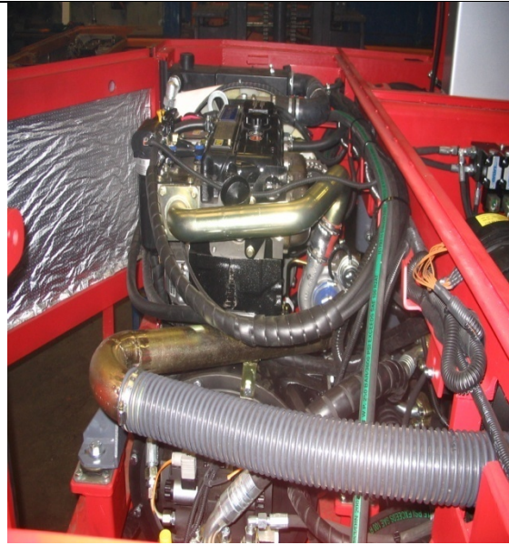
Pohled na motor a hydrogenerátor
