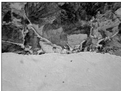
Obr. 4 Proeutektoidní ferit v oduhličeném pásmu (zv. 250x)
