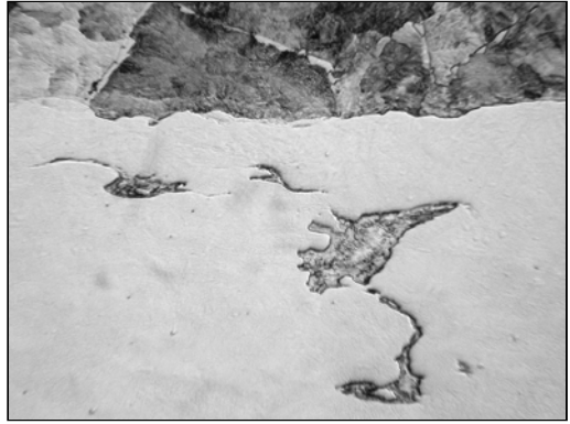
Obr. 7 Oblast vyššího promíšení (zv. 250x) Fig. 7 Area with the higher mixing (Magn.250x)
