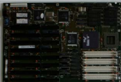
Základní deska AT – plná velikost (1) Základní deska AT, která je typická pro počítače s procesorem Intel Pentium 486. Tato deska je charakteristická svou velikostí a formou. Její rozměry jsou 305 x 425 mm. Tato deska je charakteristická svou velikostí a formou. Její rozměry jsou 305 x 425 mm.
