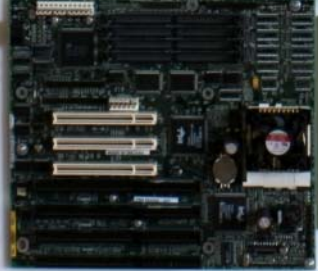
Základní deska velikosti Baby-AT (3) Základní deska Baby-AT, která je typická pro počítače s procesorem Intel Pentium 486. Tato deska je charakteristická svou velikostí a formou. Její rozměry jsou 286 x 244 mm. Tato deska je charakteristická svou velikostí a formou. Její rozměry jsou 286 x 244 mm.
