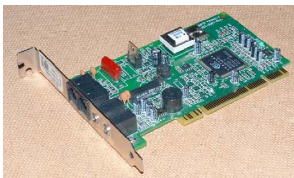
Obrázek 25: Faxmodemová karta pro slot PCI, rok 2000; Zdroj: [autor]
