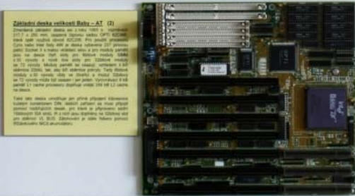
Základní deska velikosti Baby-AT (3) Základní deska Baby-AT, která je typická pro počítače s procesorem Intel Pentium 486. Tato deska je charakteristická svou velikostí a formou. Její rozměry jsou 286 x 244 mm. Tato deska je charakteristická svou velikostí a formou. Její rozměry jsou 286 x 244 mm.
