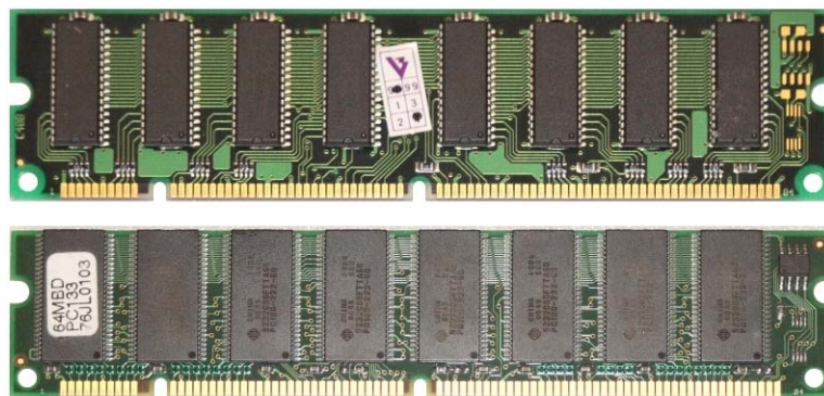
Obrázek 29: Moduly paměti SD RAM; Zdroj: [autor]
