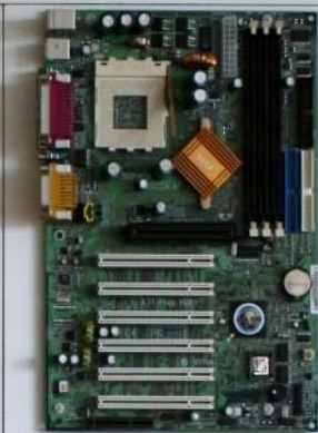
Středně veliká základní deska formátu ATX (3) Středně veliká základní deska formátu ATX, která je typická pro počítače s procesorem Intel Pentium 486. Tato deska je charakteristická svou velikostí a formou. Její rozměry jsou 286 x 244 mm. Tato deska je charakteristická svou velikostí a formou. Její rozměry jsou 286 x 244 mm.
