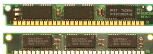
Obrázek 27: Paměťové moduly SIMM - 30 vývodů; Zdroj: [autor]
