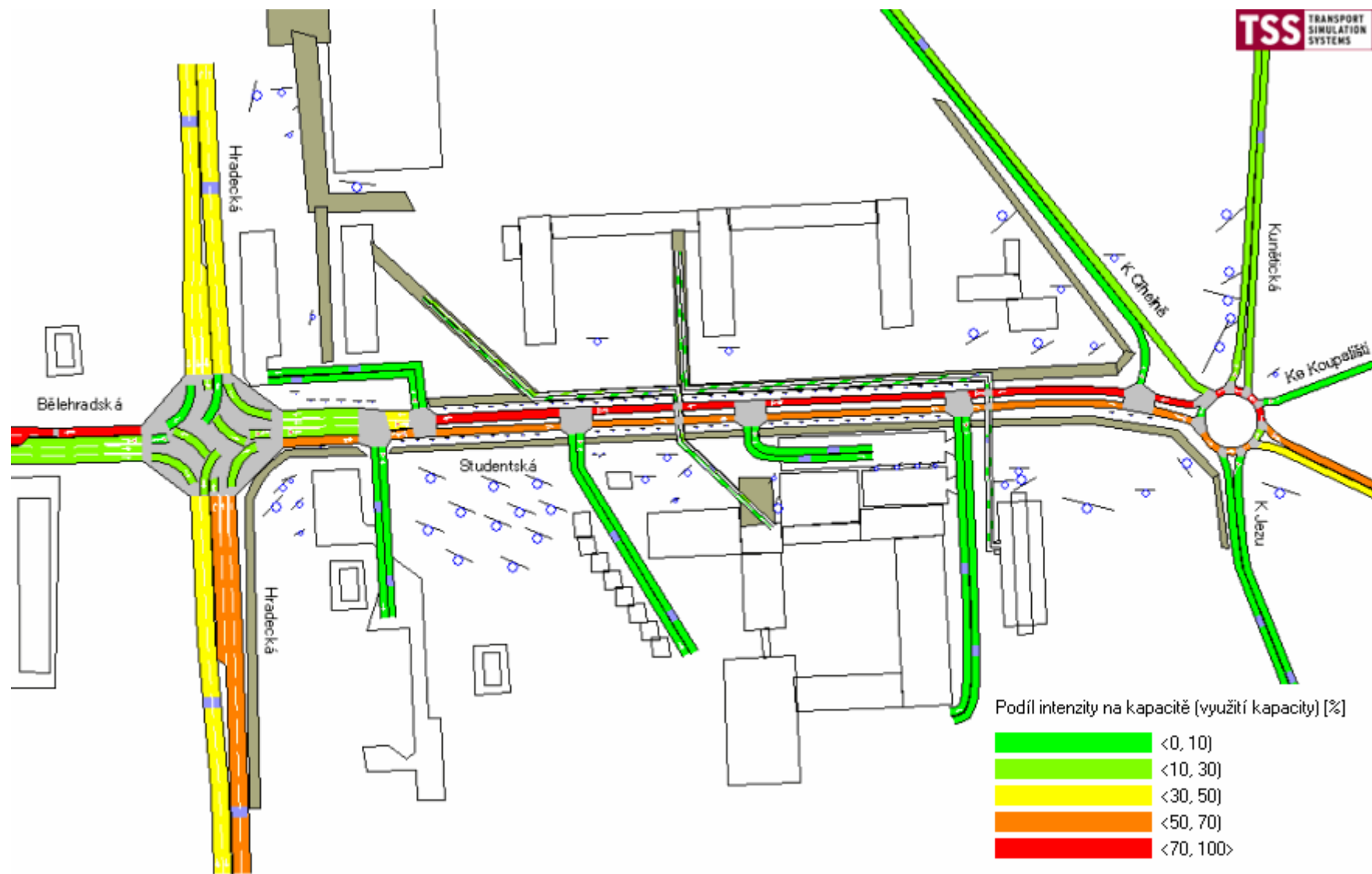
Podíl intenzity na kapacitě (využití kapacity úseků) v %
