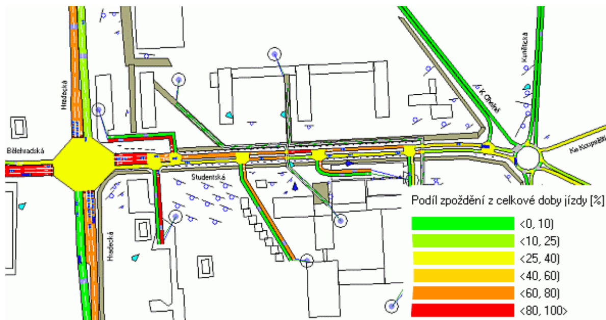
Obr 37. Podíl zpoždění na celkové době jízdy v nejméně příznivé replikaci č. 913
