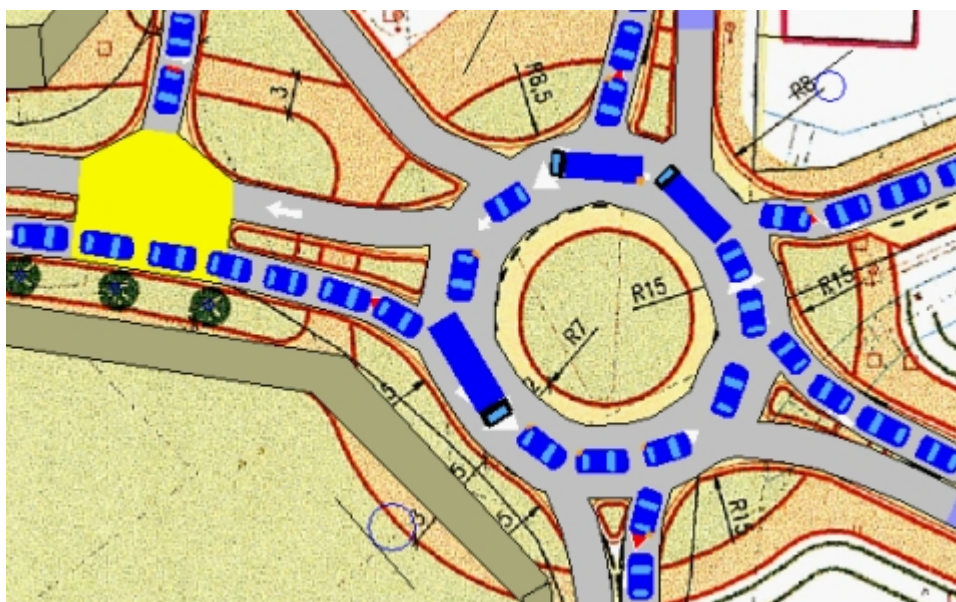
Obr 26. Vzájemné zablokování vozidel na okružní křižovatce
