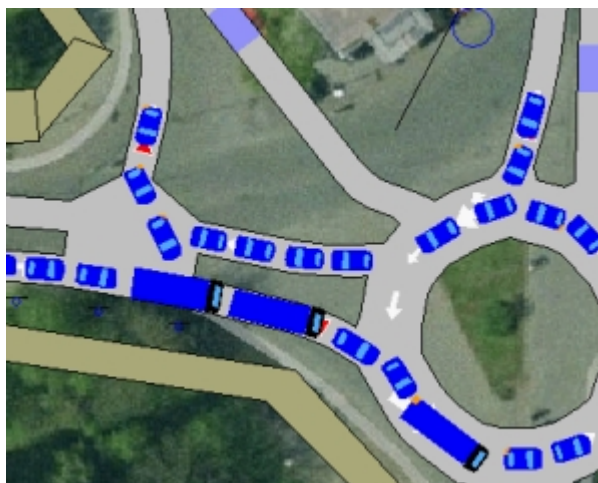
Obr 21. Nevhodné najetí vozidla do prostoru křižovatky neoznačené příznakem „Yellow Box“
