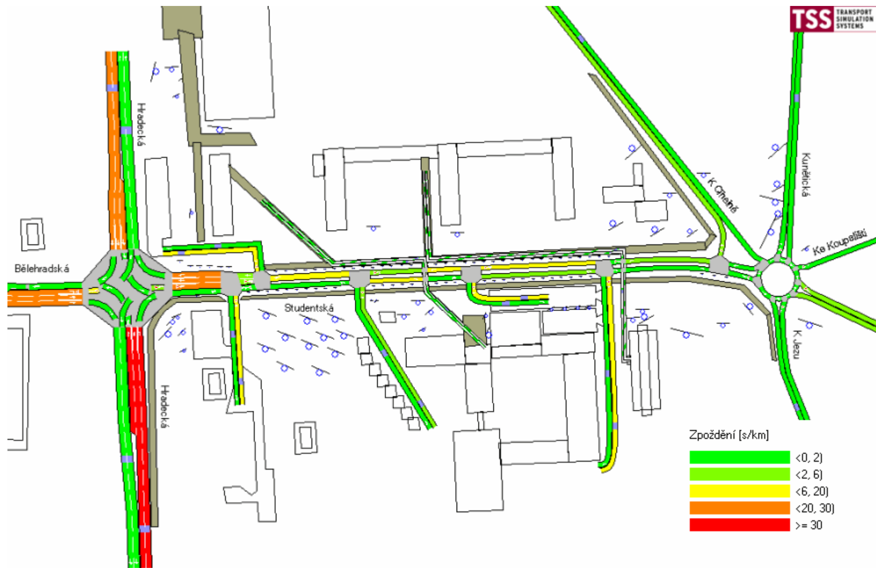
Průměrný čas zdržení (oproti ideálnímu průjezdu) v s/km – zahrnuje i dobu čekání na zelenou
