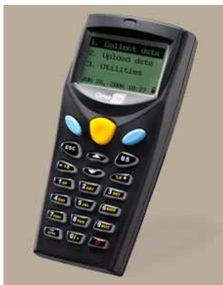
Obrázek č. 7: Mobilní bezdrátový terminál s WiFi a akumulátorovou baterií 8071
