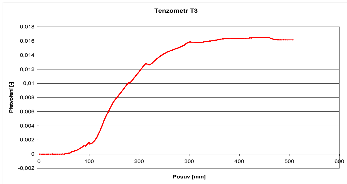
Obr. 70 Výsledný signál z tenzometru T3
