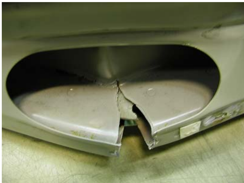
Obr. 40 Prasklá výztuha po zkoušce [5]
