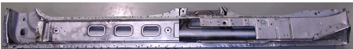
Obr. 29 Spodní část vyříznutého prahu [5]
