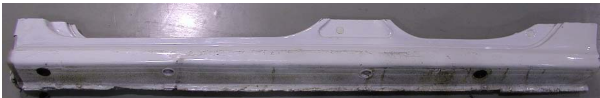
Obr. 28 Vrchní část vyříznutého prahu [5]
