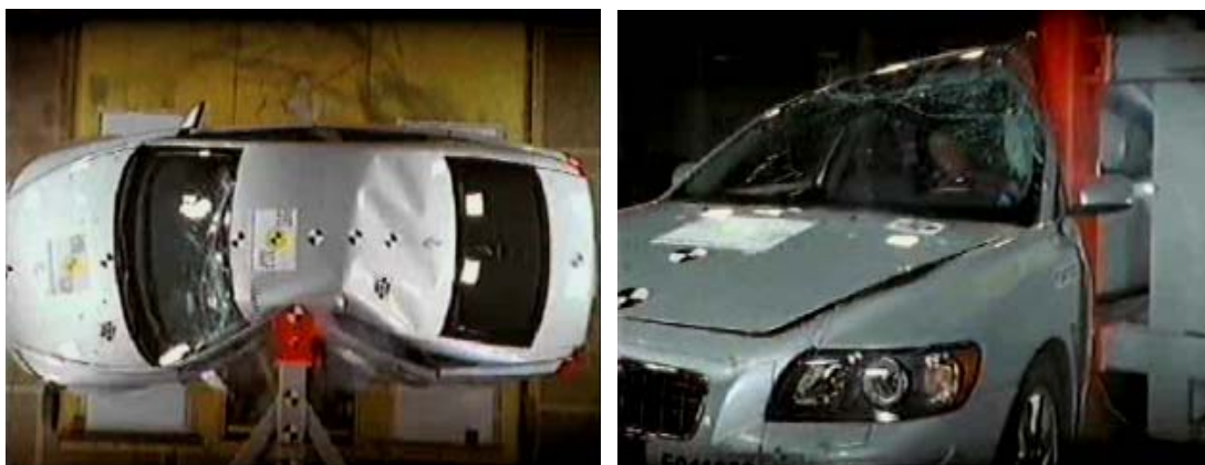
Obr. 4 Boční náraz na sloup [12]
