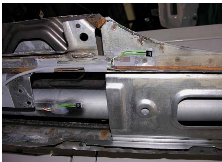
Obr. 34 Tenzometry na prahu [5]
