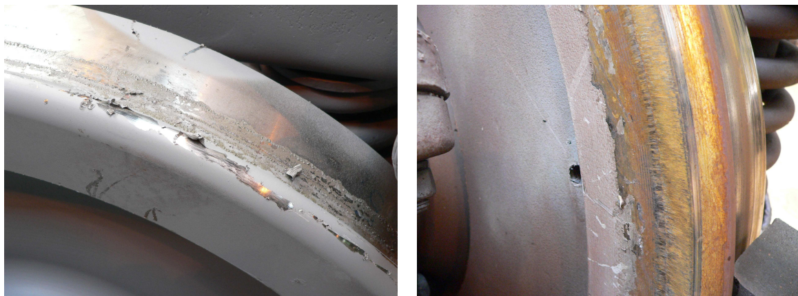
Obr. 10 – barva nanášená na podvozky souprav 81-71M se často objevuje i na jízdní ploše kol. Vpravo je vidět i opotřebení okolku od přídržnic
