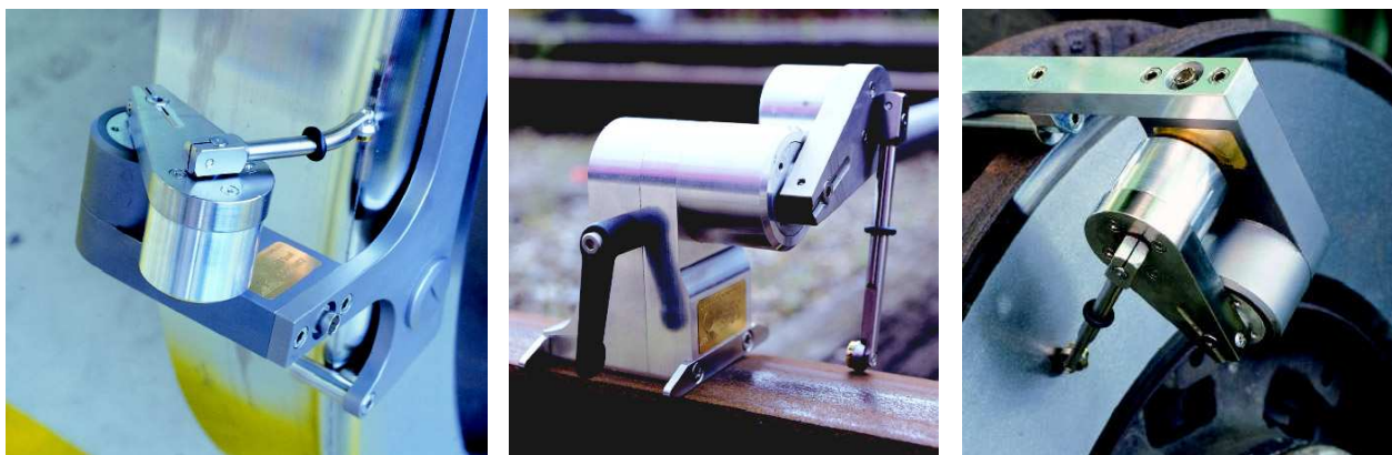
Obr. 7 – Miniprof Wheel (vlevo), Miniprof Rail (uprostřed) a Miniprof Brake (vpravo)
