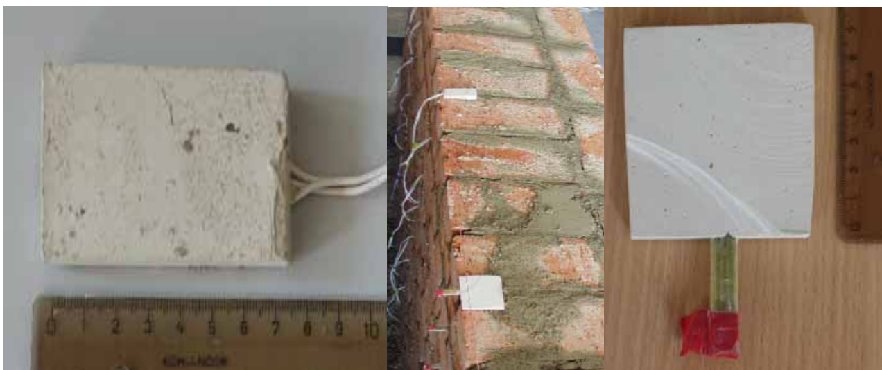
Obr. č. 17 – přední strana zdi, umístění snímačů S 11 - S 40 a C 1 - C 3
