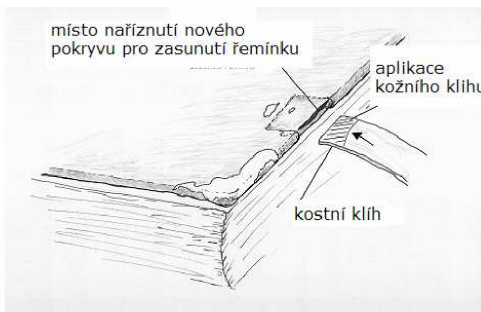
Obr. 11 Aplikace nových řemínků na desky.
