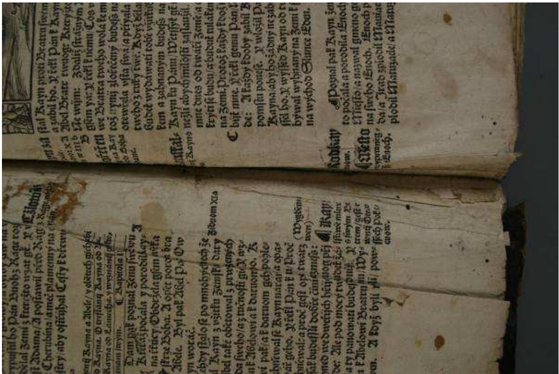
Obr. 54 Častý typ poškození v bloku – zvlnění, zatekliny, klišové skvrny, stav místa před restaurátorským zásahem
